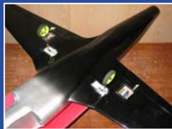
Les jambes de train définitives maintenues avec des bagues d'arrêt de roues.
