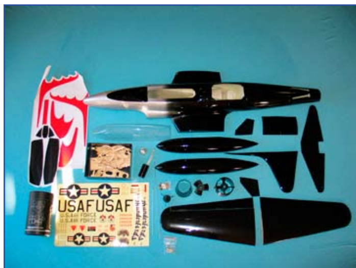
Le kit du T-33 est livré avec l'excellente turbine WM400 Velocity RC.
