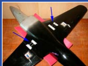
Le collage des blocs à l'époxy à l'intrados.
