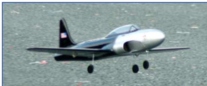
Le T33 est un avion rapide, le décollage intervient à une vitesse proche de 60 km/h rendant impossible un lancer main.
