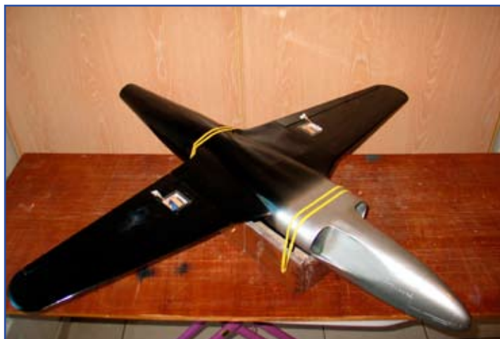
Le collage des demi-ailes requiert un peu de soin pour respecter le dièdre et ne pas introduire de vrillage.
