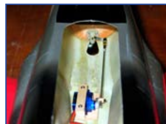
Un servo de 9 g commande le train avant.
