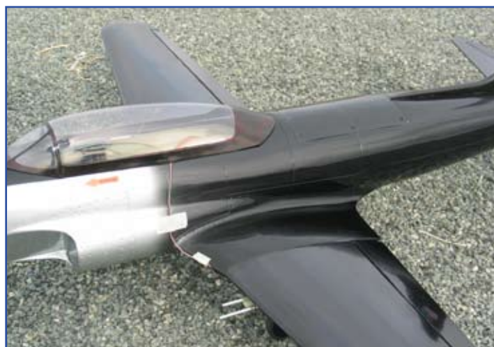
Le module How Fast est scotché sur l'aile du T-33 pour mesurer avec précisions les performances.
